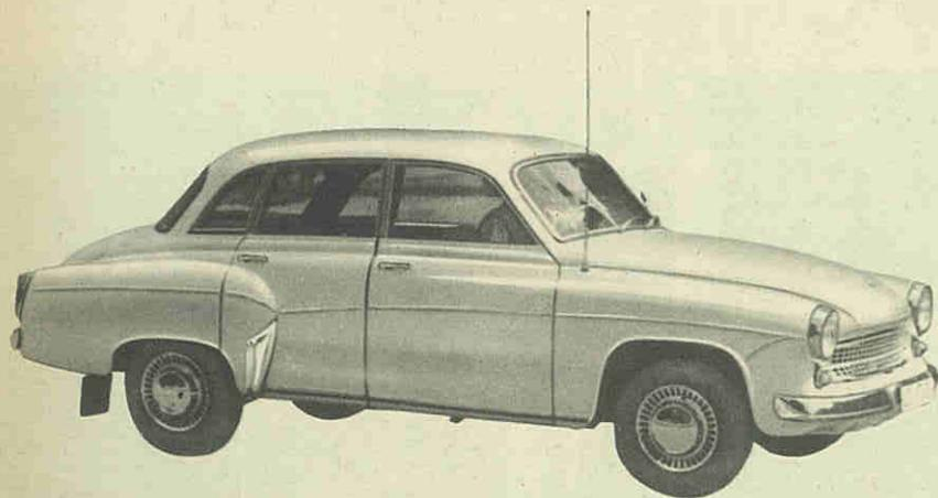
Der Wartburg 312/1 mit dem völlig neuen Fahrwerk unterscheidet sich rein äußerlich vom alten Baumuster nur durch die kleineren Laufräder
